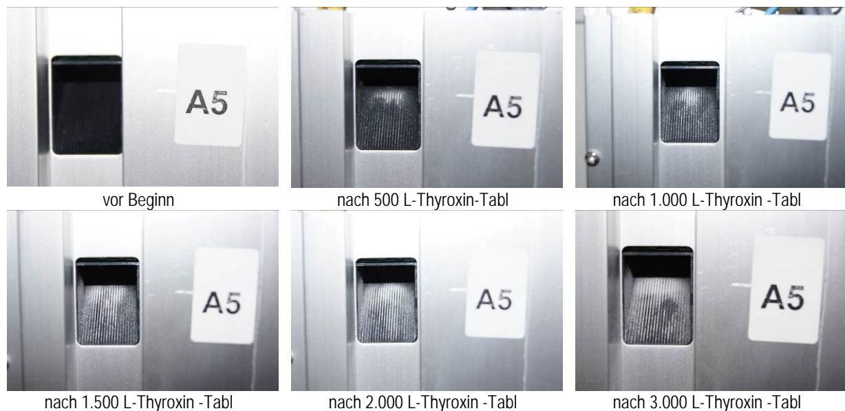
Abb. 4-9: Staubrasenentwicklung am oberen Zufuhrschacht unter L-Thyroxin
