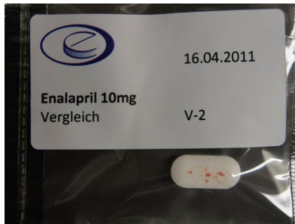
Abb. 20: Vergleichsdarstellung einer Placebotablette mit der Menge an Abrieb, die in etwa der Allergiedosis an Enalapril (8µg Enalaprilmaleat) entspricht
