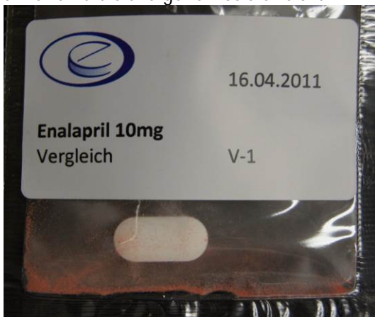
Abb. 19: Vergleichsdarstellung einer Placebotablette mit der Menge an Abrieb, die 1/3 der minimalen EnalapriLDosis (0,83mg Enalaprilmaleat) entspricht
