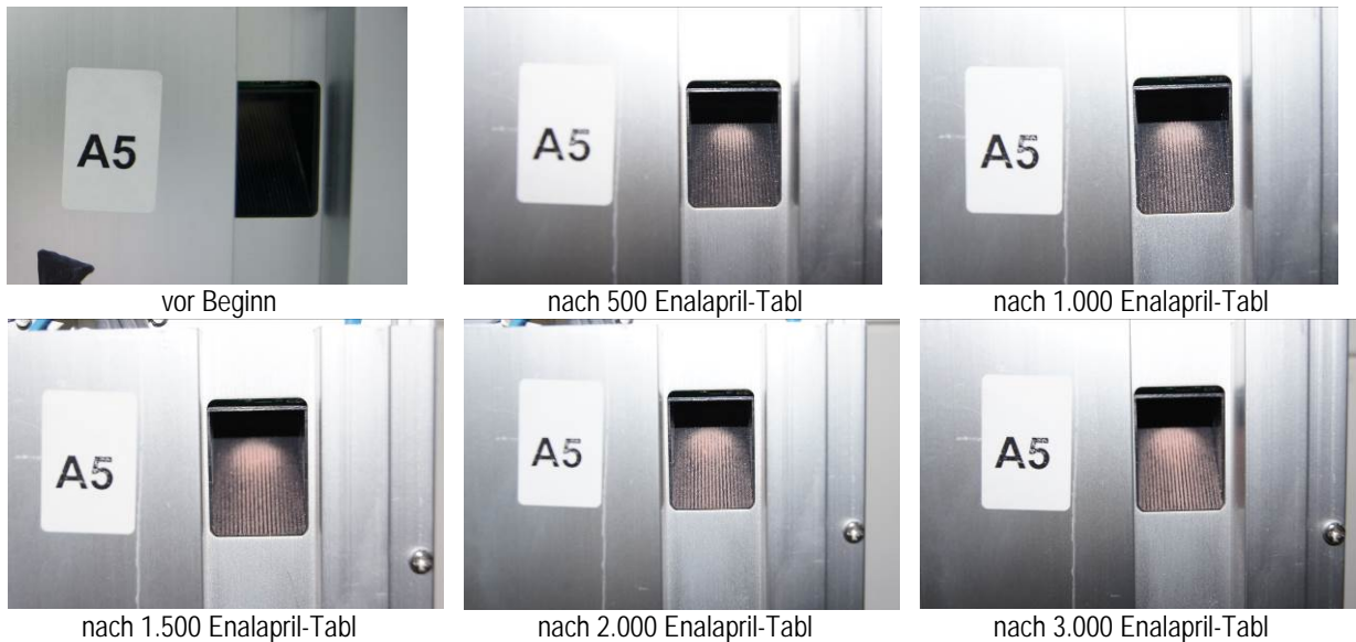
Abb. 11-16: Staubrasenentwicklung am oberen Zufuhrschacht unter Enalapril
